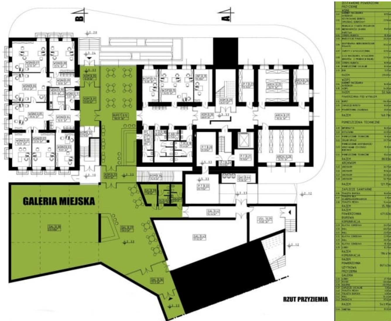
Rys.6,7_Rzut i schemat przyziemia
